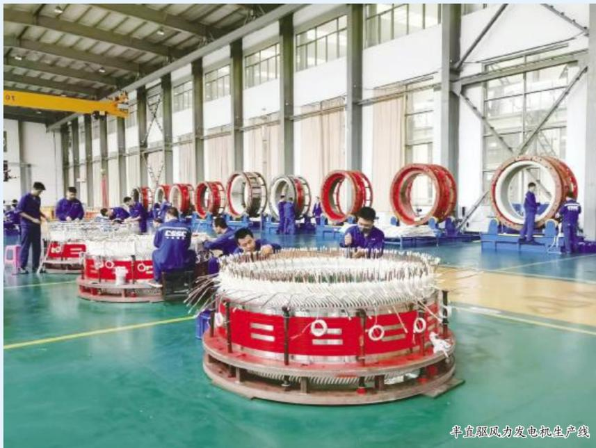
半直驱风力发电机生产线
