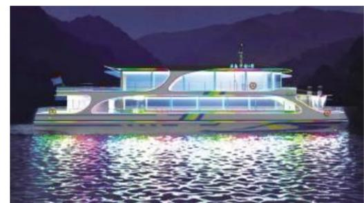
本报讯 日前,中国船舶集团有限公司旗下第七一二研究所签订湖南省纯电动客船批量供货合同。该批纯电动船总长30米,型宽7.2米,采用该所自主高可靠性直流组网技术,装配高效永磁推进电机,续航时间达6小时。
