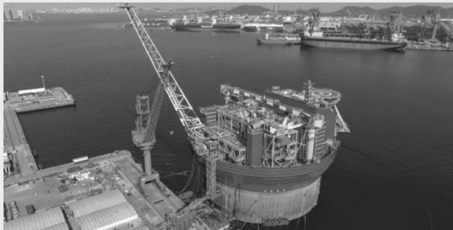
内首次应用技术和20余项工艺创新,全面掌握了最新圆筒型FPSO建造和总装能力,集成速度和精度达到世界先进水平。
