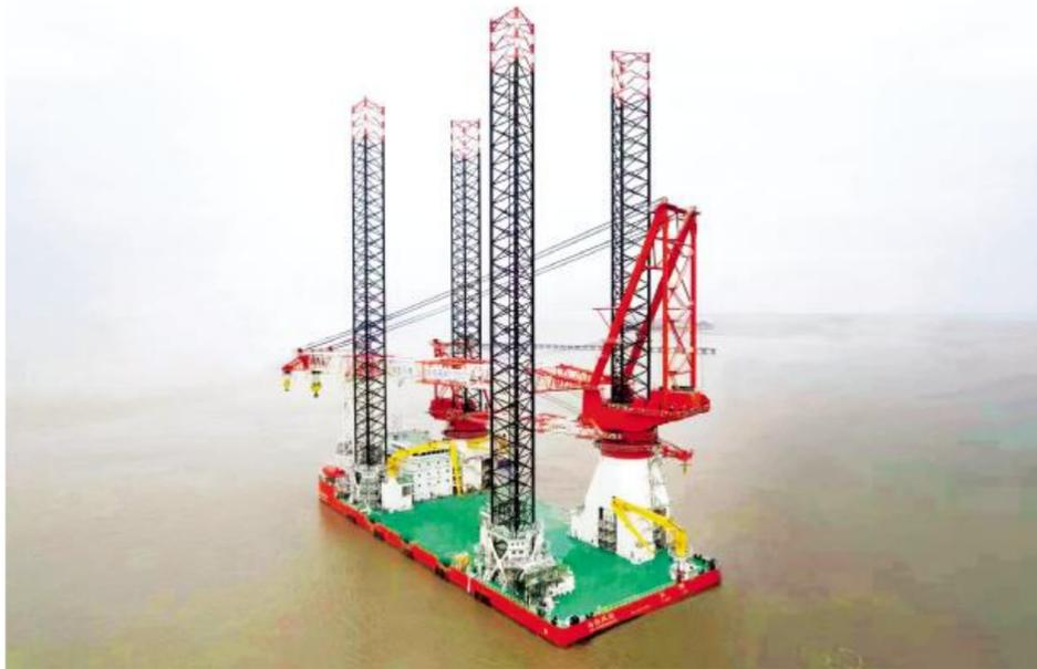
海域具有水深浪高、海况条件恶劣、施工技术难度大等特点,“海龙风采”号船东——江苏海龙风电科技股份有限公司董事长李海斌介绍,该公司承接项目的安装对象主要为11兆瓦风机,所在海域水深40米以上,安装要求比此前国内普遍的35米水深以内浅海风电项目高得多。5月中旬,海龙公司另一台设备“海龙瑞彩”号自升式风电安装平台已经赶赴当地投入安装作业,同样由华南船机配套的600吨风电安装起重平台高效作业,已在该海域成功安装了10台风机。
