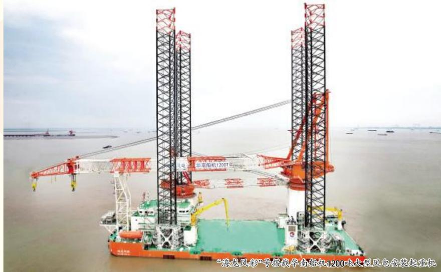
“海龙风彩”号搭载华南船机1200吨大型风电安装起重机
