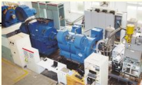
成功研制的国内首兆瓦级超导电机
