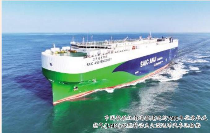
中国船舶江南造船建造的7600吨液化天然气(LNG)双燃料动力大型远洋汽车运输船
