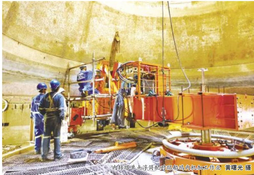
内转塔单点浮筒配对环船坞内机加工作业 黄曙光 摄
