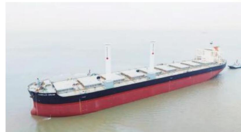
至关重要。“山茶之梦”号采用的水平安装方式在国内尚属首次,对安装精度和吊装操作提出了极高的要求。转子帆上100个孔位与底座的精准安装,不仅关系转子帆安装稳固性,更影响其运行时的风力助推效果。“山茶之梦”号全长299.94米,型宽50米,型深24.7米,是一艘20万吨级运输铁矿石的散货船。该船进厂后,舟山中远海运重工总管小组实地勘验,细致测量,对技术改装方案进行优化。该公司总管小组、船东、设备厂
