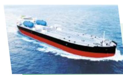
▲16.2万载重吨氨燃料动力苏伊士最大型成品油船效果图
