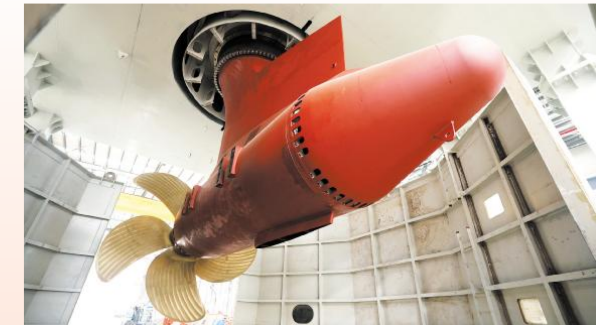
七〇四所自主研发设计制造的国产首台套 10兆瓦T型吊舱推进器 实现了 100% 国产化，标志着我国在大功率吊舱推进技术领域取得了具有里程碑意义的创新成果。
