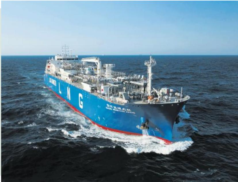
注、加注船加注等4类。其中，加注船加注指在装卸码头或锚地利用加注船为受注船提供LNG燃料加注服务。该加注模式可在沿海港口或锚地开展LNG加注作业，适用于沿海大型LNG动力船舶燃料加注，同时兼顾为岸基加注站、趸船加注站等进行补液作业。
